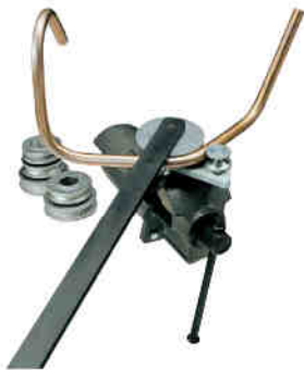
Giętarka warsztatowa M18 Zakres giętych rur: 6 ÷ 18mm x 4mm Materiał: AISI 316 TI, ST 37.4 Mocowanie: np. w imadle; trzpień mocujący i skrzynka warsztatowa- w komplecie.
