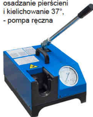
Praska warsztatowa 15MAN Osadzanie pierścieni: 6 (S) ÷ 15mm (L) Materiał: AISI 316 TI - ST 37.4 Mocowanie: np. w imadle; długość dźwigni: 80cm; masa: 12kg, wym.: 285x105x106mm
